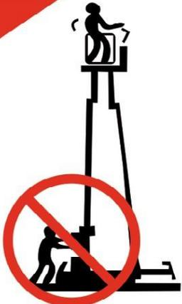
Передвижение подъемника с поднятой платформой может привести к его опрокидыванию, угрозе жизни и здоровью оператора и окружающих
