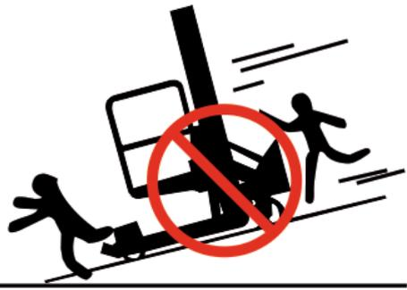
Не оставляйте подъемник на наклонной плоскости. При движении по склону следите за препятствиями
