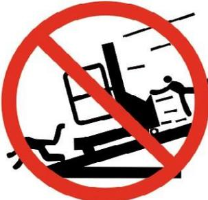
Проверьте место работы на отсутствие препятствий над головой или других возможных опасностей. Не опускайте платформу, пока пространство снизу не будет свободно от персонала и препятствий. Будьте осторожны при передвижении подъемника по наклонной поверхности. Держитесь в стороне от опускающейся платформы.
